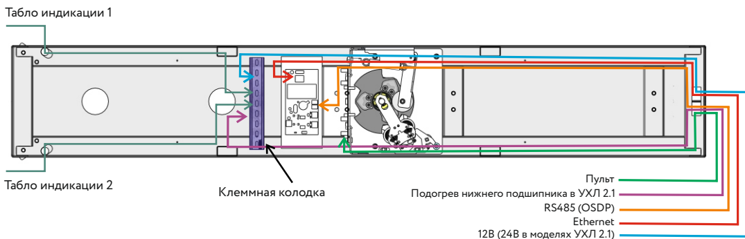
Рисунок 9.23 - Схема подключения турникета 3V Model X / Xi
